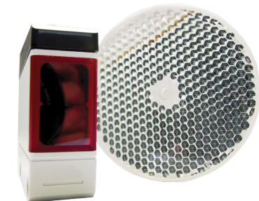
FOTOCÉLULAS DE ESPELHO , retro refletora com alcance até 12m -25°C .... 55°C / IP67
